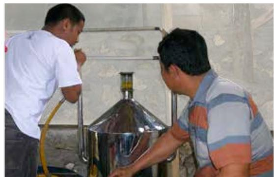
• Proses penyulingan minyak atsiri dengan air dan uap (sistem kukus)
