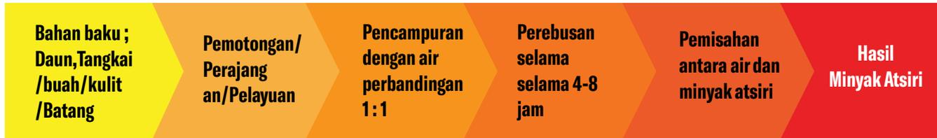
**Penyulingan dengan Air dan Uap (*Water and steam distillation*)**
